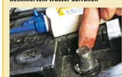
Schützen: Polfett vermeidet Korrosion, verringert so den Widerstand
