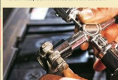
Reinigen: Der Hobel säubert die Klemmen und Pole der Batterie
