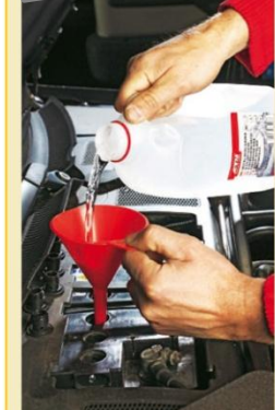
Batterie mit Stopfen: mit destilliertem Wasser auffüllen
